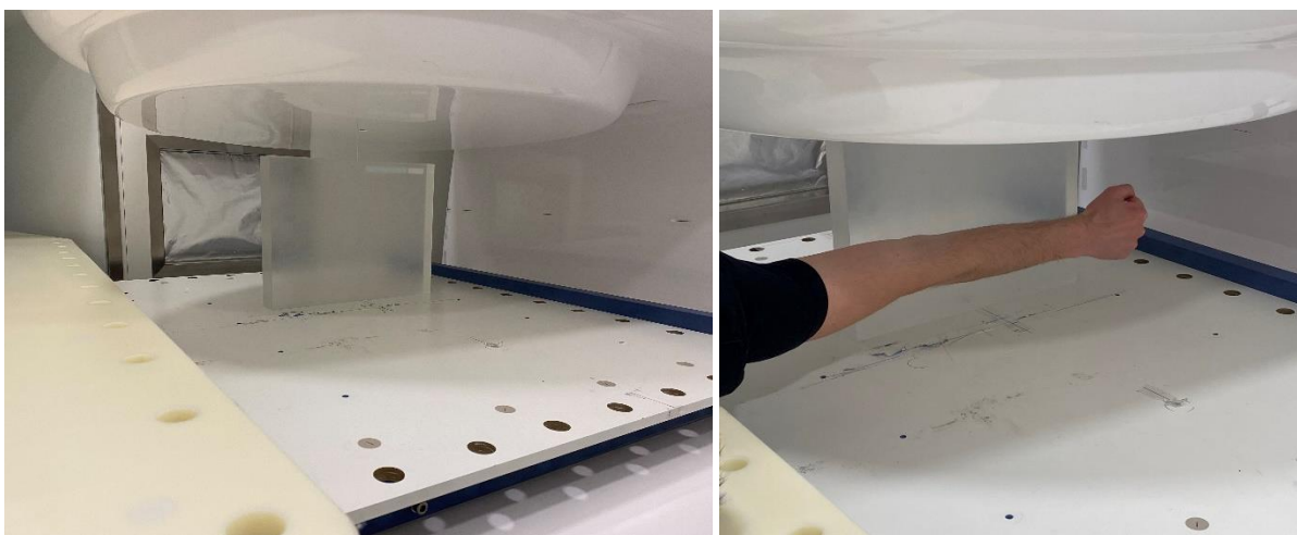
Abb. 1 Aufnahmen des MRT-Scanners am OncoRay mit Range Shifter . Rechts: Darstellung einer Bestrahlungssituation im Zentrum des MRT für ein Weichteilsarkom im Unterarm, wofür die Verwendung eines Range Shifters zwingend erforderlich ist.
